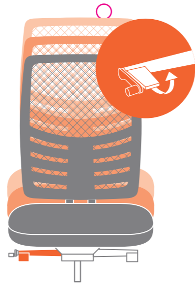
SYNCRON Regolazione altezza sedile Adjusting the height of the seat Réglage en hauteur de l'assise Sitzhöhe Altura del asiento
