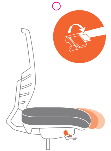
SYNCRON Regolazione profondità del sedile Adjusting seat depth Réglage de la profondeur de l'assise Sitztiefeinstellung Ajuste de la profundidad del asiento
